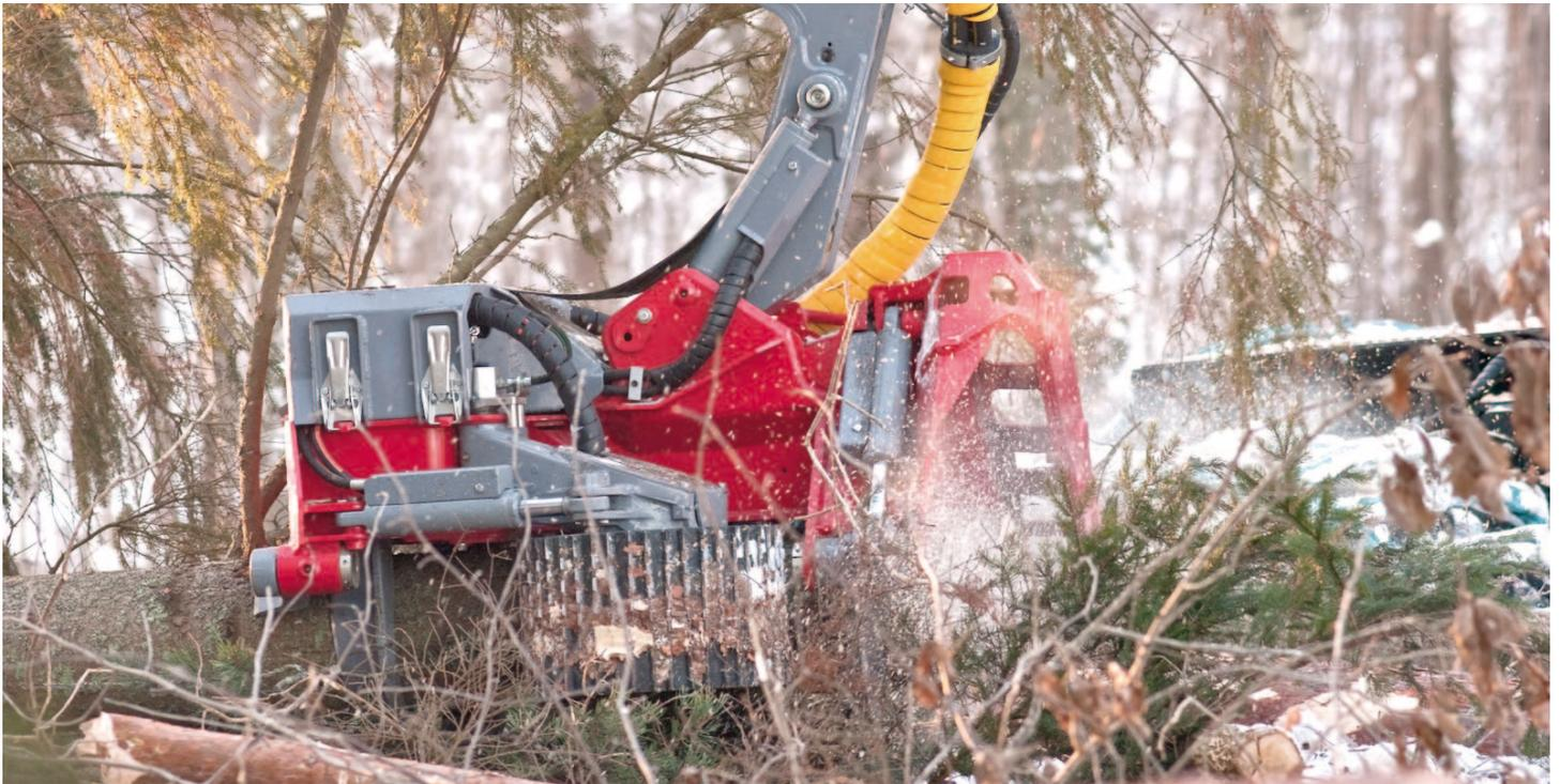
Das neue Log Max 6000 Twin ist ein leichtes Endnutzungsaggregat, wobei die Entastungseinheit aus fünf beweglichen Messern besteht und auf der von Log Max patentierten Messersteuerung zur Verminderung der Reibung und Erhöhung der Zugkraft basiert.
