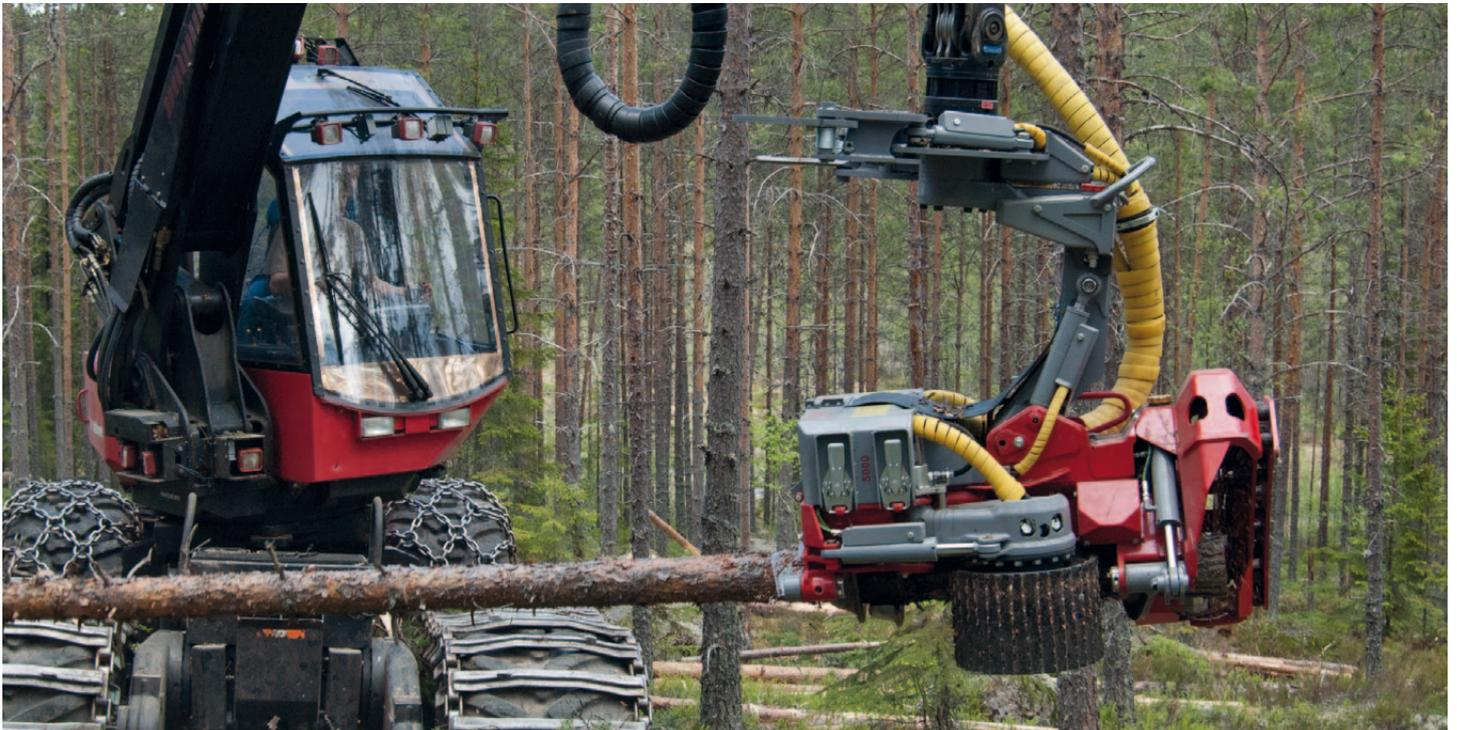
Das Log Max 5000D ist ein richtiges Allroundaggregat und eignet sich für den Einsatz in der Erstdurchforstung bis zur Ernte von mittelstarkem Holz.
